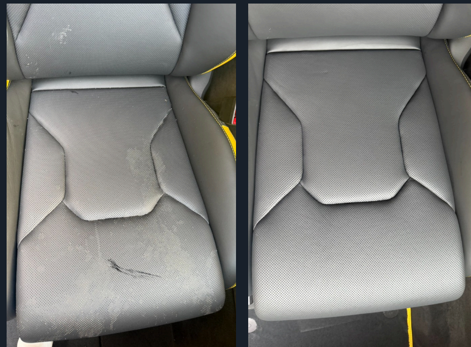
実際の作業写真（シートの作業前と作業後）
